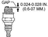
Figure 23. Spark Plug Gap
